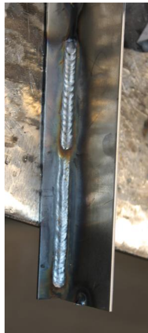
Bild 7: Steigenaht am Dünublech mit Pendelraupe
