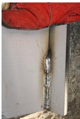
Bild 3: Demonstration der neuen Lichtbogenarten mit PMC (Puls Multi Control) durch Kai Maikranz, Fa. Fronius Deutschland GmbH, Neuhof
