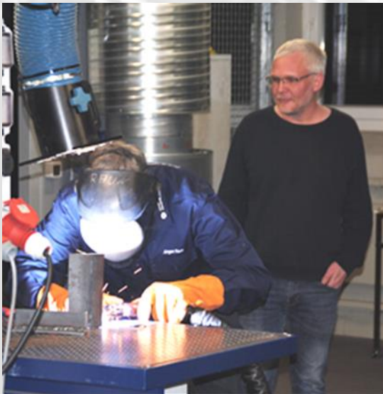
Bild 3 und Bild 4: Tim Mika, Fa. Schüßler Welding Solution GmbH, Hamburg, bei der Demonstration eines herstellerunabhängigen Systems zur Schweißrauchabsaugung am Brenner beim MSG-Schweißen
