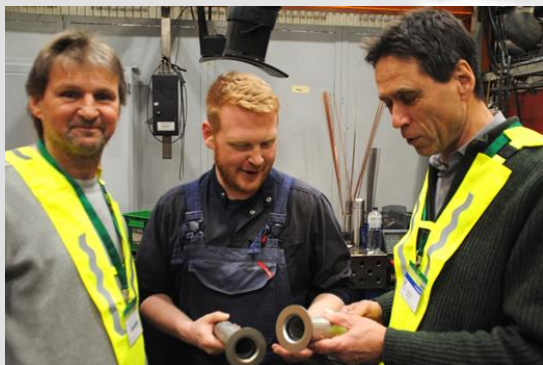
Bild 4: VA Rohrstützen, geschweißt mit einer offenen Orbitalzange
