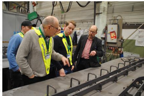
Bild 3: Herstellung einer Seitenwand für eine Waschmaschine
