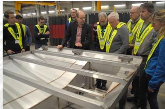
Bild 5: Diskussion zur finalen Oberflächenbearbeitung, hier Tauchbadbeizen
