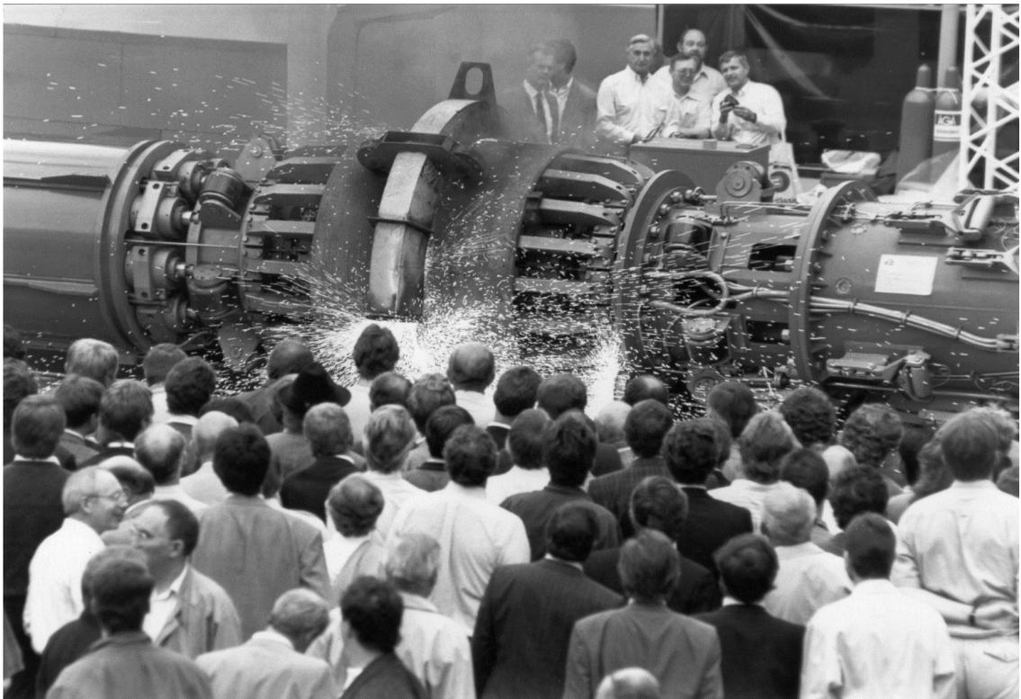
Bild 30: Präsentation des Abbrennstumpfschweißens von Großrohren durch das E. O. Paton-Institutes 1993 auf der Messe in Essen
