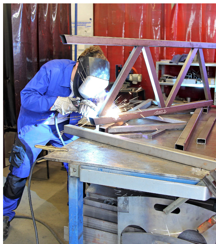
Konstruktionsmechaniker-Azubi schweißt Bauteil
