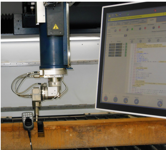
Schneidoptik mit Bediendisplay
