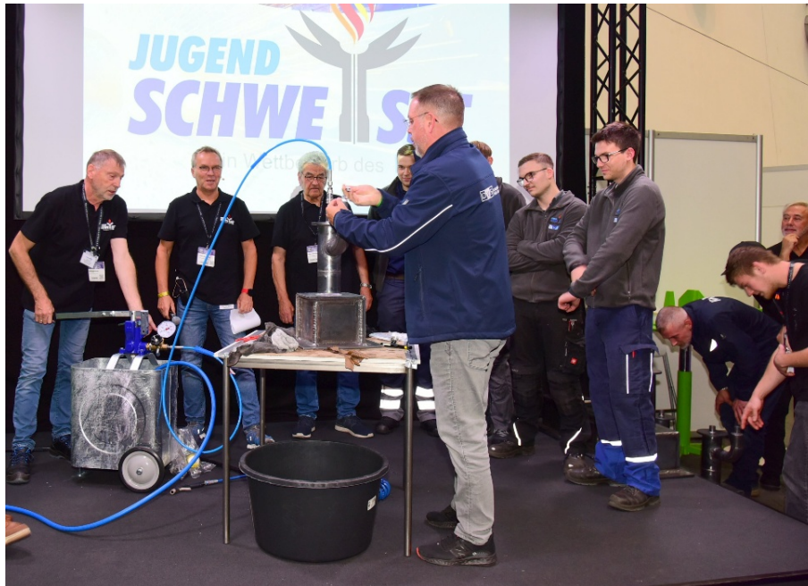
Bild 3: Druckprobe des vom Team Bayern geschweißten Druckbehälters
