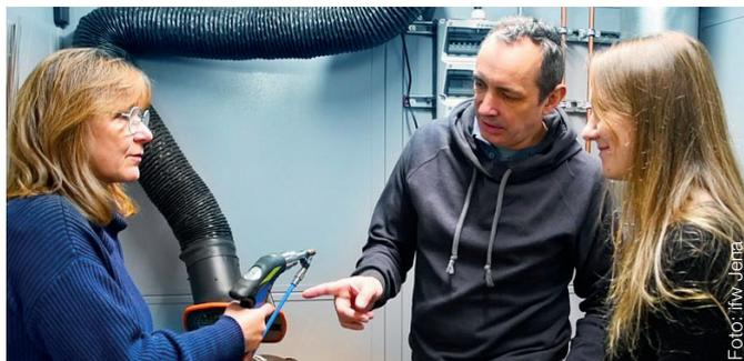
Untersuchungen zum handgeführten Laserstrahlschweißen
