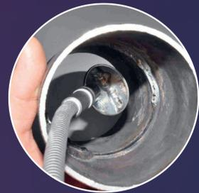
Mit einem beleuchteten Spiegel als Hilfsmittel wird hier die Wurzel einer Rohrschweißung überprüft.
