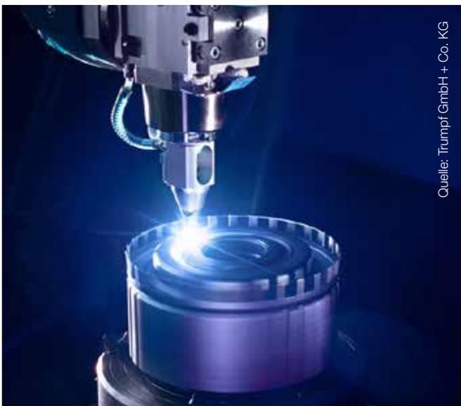
Bild 1: Laserstrahlschweißen eines Getriebeteils.
