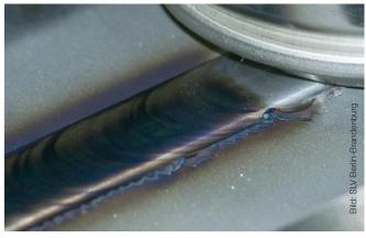
Rührreibschweißverbindung an S700MC mit Schutzgas
